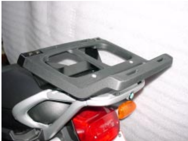
Abb. 3: installierte GG Halteplatte mit BMW Topcase Halter
