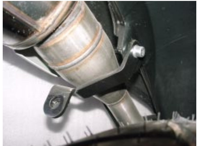
Abb. 1 vordere Befestigungslasche am Endschalldämpfer, in Fahrtrichtung links
