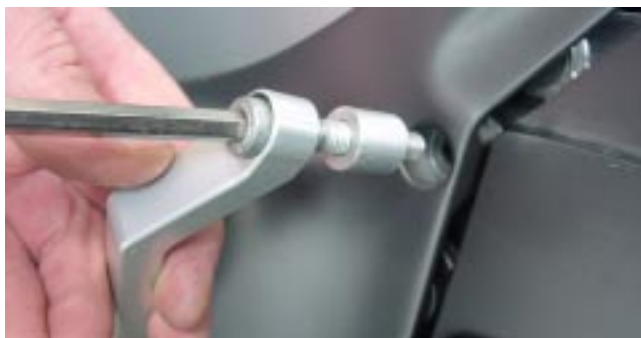
Abb. 1: Montage der seitlichen Ösen
