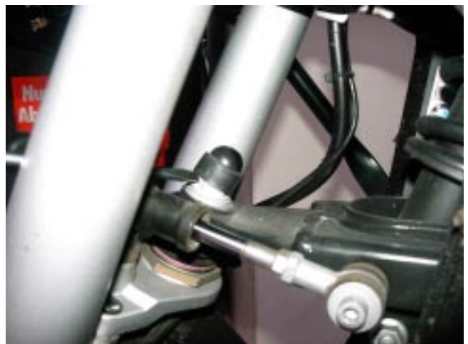
Abb .3: Abhebeln der Kunststoffkappe
