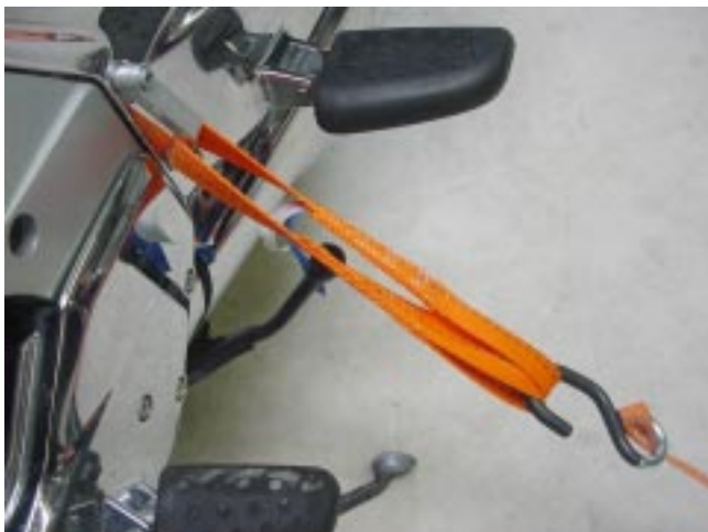
Abb. 6: Seitliche Transportösen mit Gurtschlaufe 60 cm
