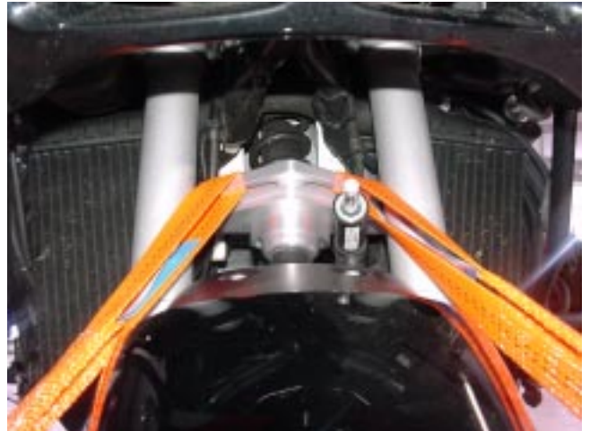
Abb. 7: Vordere Halterung mit Gurtschlaufen 80 cm
