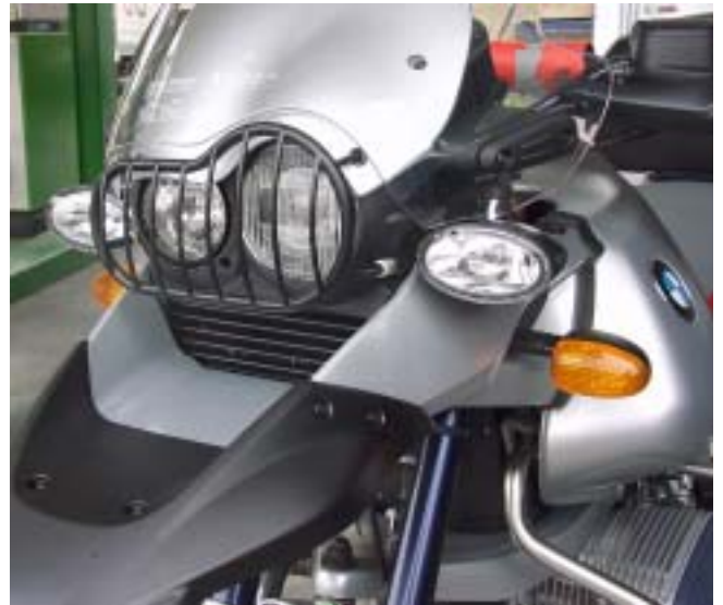
montierte GG Zusatzscheinwerfer an einer BMW R 1150 GS Adventure
