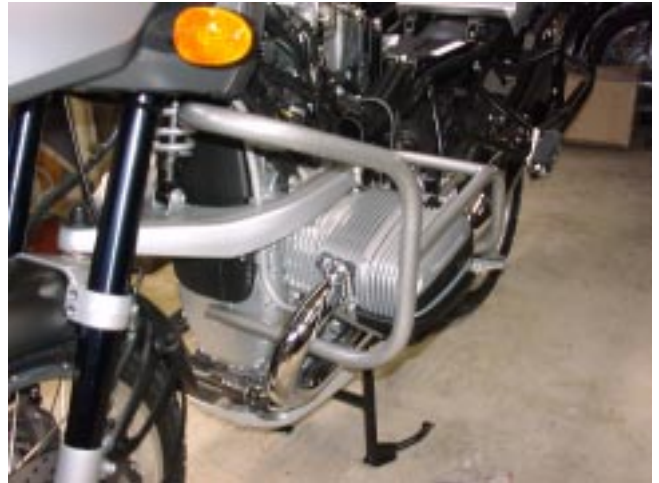
auf der linken Seite montierter Tank-/Zylinderschutzbügel
