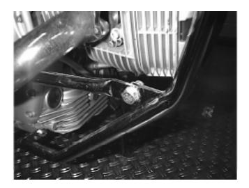
Nachdem das Verbindungsrohr zwischen beide Schutzbügelhälften gesetzt wurde, kann der Schutzbügel ausgerichtet werden.
