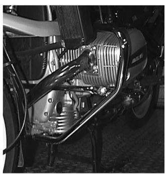
Mit dem festen Anziehen aller Schrauben und der anschließenden Montage des Unterfahrschutzes ist der Anbau abgeschlossen.
