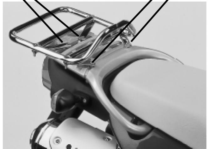
In diesen Distanzhülsen werden vorne die kurzen, hinten die langen Top-Träger Halter mit den Inbusschrauben lose verschraubt.
