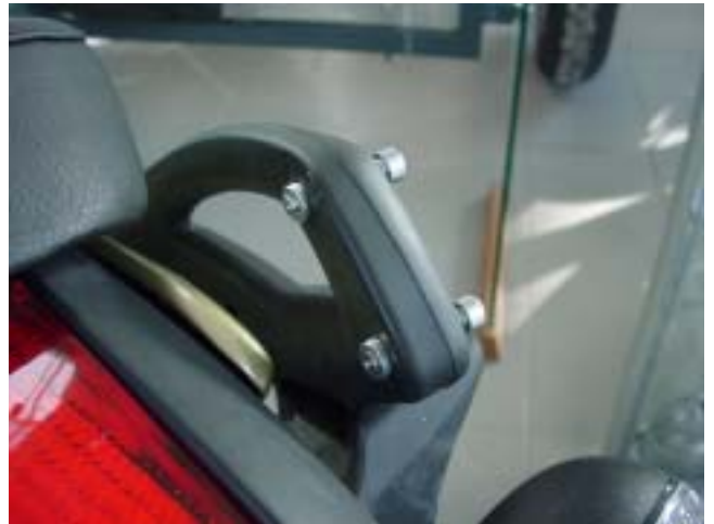
Abb .2 eingesteckte Hülsen und Inbusschrauben
