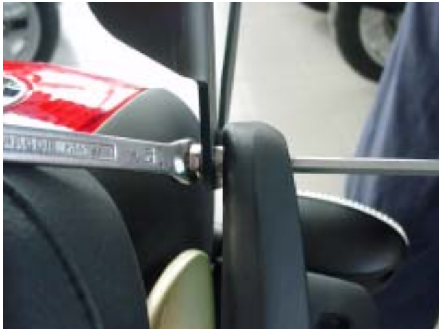
Abb . 4 Schrauben nacheinander, von unten angefangen festziehen.
