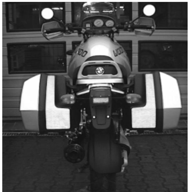
Abb. 3: installierte gleichgroße BMW System Koffer mit Reflexfoliensatz, der bei Tageslicht schwarz ist; bei Dunkelheit angestrahlt wird das Licht weiß reflektiert.
