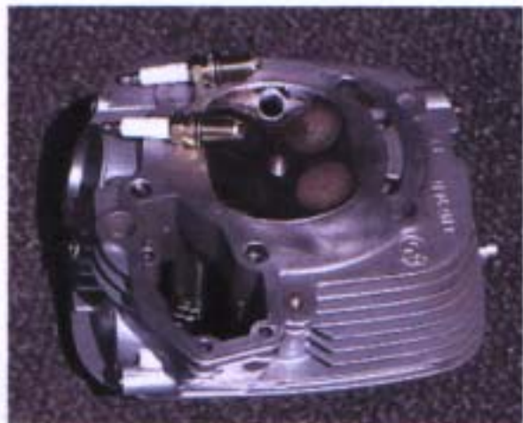
Doppelfunke: Zwei Zündkerzen pro Brennraum
