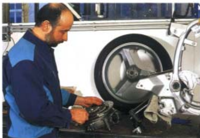
Hier entsteht ein sportlicher Umbau auf R 100 R-Basis. Die typische PVM-Felge wartet bereits auf den Einbau
