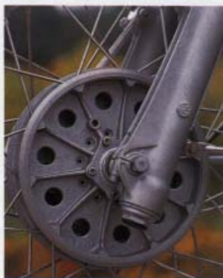
Da muss Luft rein! Die fehlende Abdeckung auf der Trommel unterstützt die Bremsentlüftung
