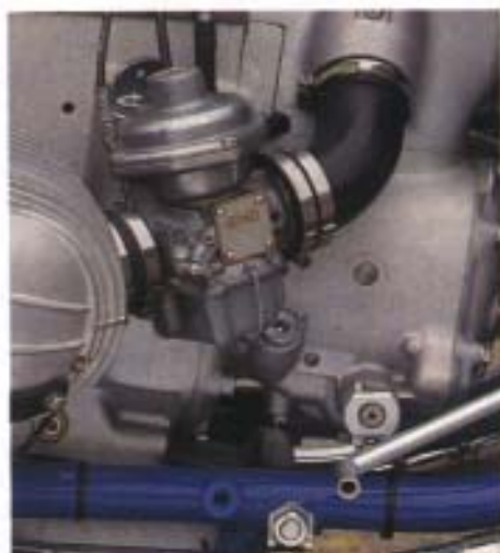
Tribut an die Alltagstauglichkeit anno 1999: Luftfilterkasten und Gleichdruckvergaser
