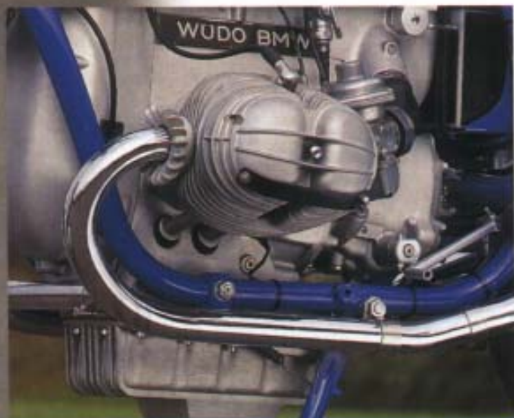
Eine gängige Modifikation in Sportfahrerkreisen: Der Motor hängt drei Zentimeter höher im Rahmen, um die Schräglagenfreiheit zu erhöhen
