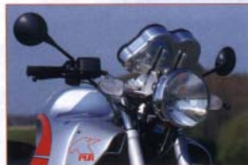
Ordentlich gelöst: Das Kabelgewusel verschwindet hinter der Alutafel
