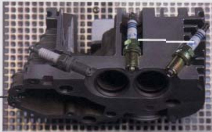
Anders als BMW (die linke Kerze) setzt WüDo die zweite Zündkerze nicht von unten, sondern von oben in den Zylinderkopf des Boxers ein.
