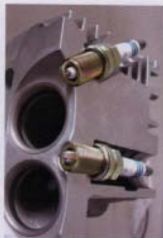
Ein-Elektroden-Platin-Kerzen für den nachträglichen Einbau
