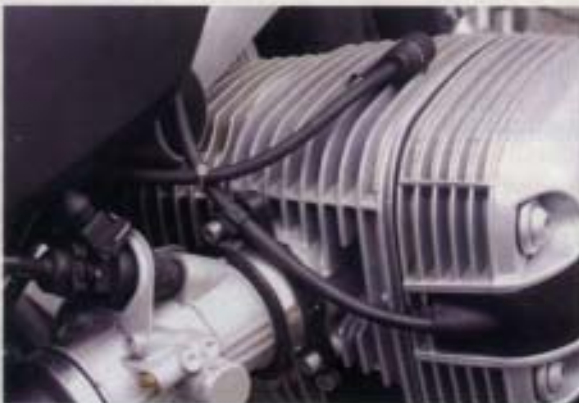
Zwei Zündkabel pro Zylinder
