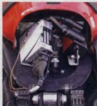
Steuergerät und zusätzliche Zündspule vorn unterm Fahrersitz
