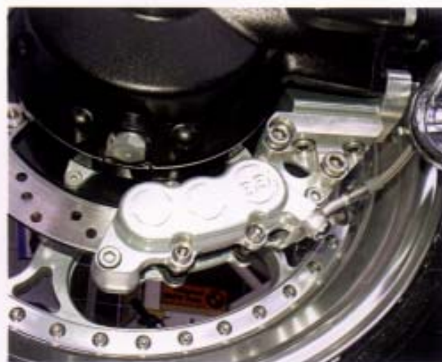
Gewaltige Bremsanlage: Original-Scheiben mit GG Sechskolben-Bremssätteln
