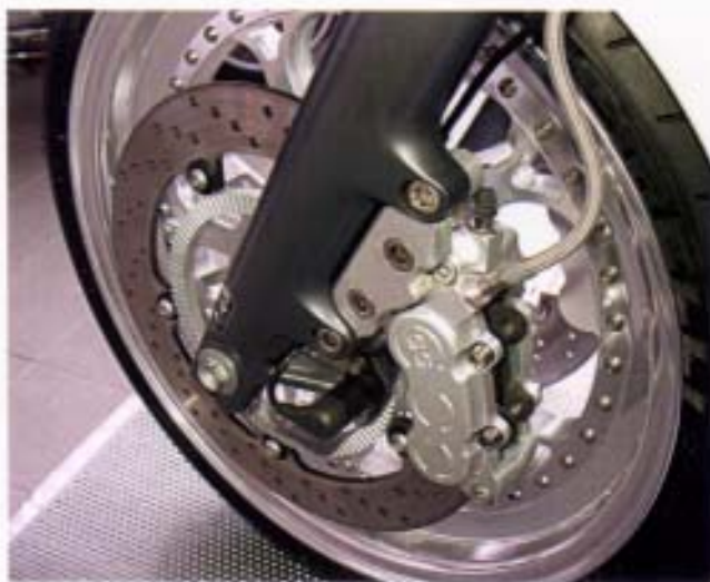
Gewaltige Bremsanlage: Original-Scheiben mit GG Sechskolben-Bremssätteln
