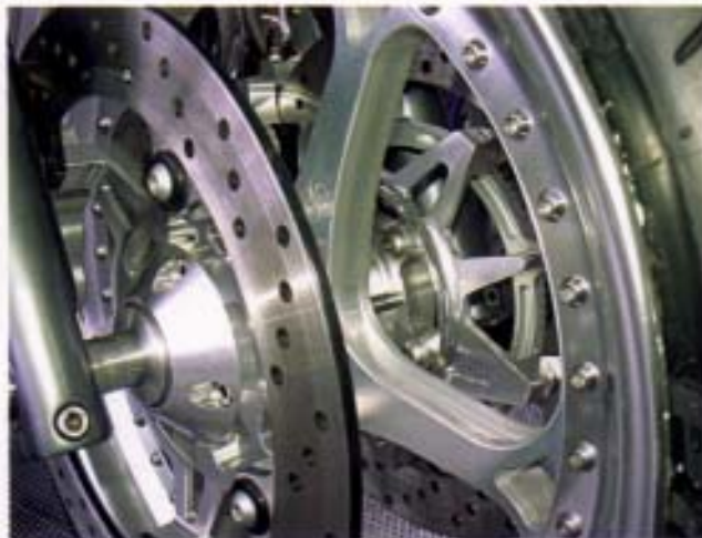
Die Außenringe der Felgen sind je Seite mit 40 Inbus-schrauben am Radstern befestigt.
