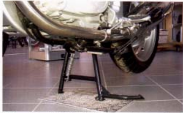
Sicherer Stand für F 650 CS durch einen Hauptständer.
