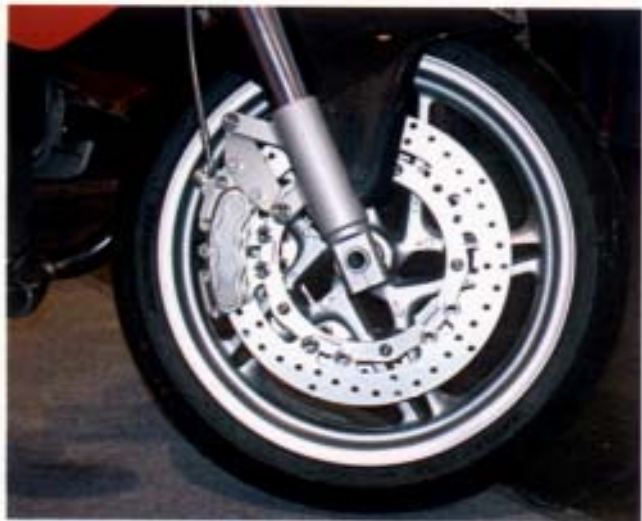
Neue Brems-Maßstäbe für R 1100 S: Spiegler Bremsscheiben und -Kolben.
