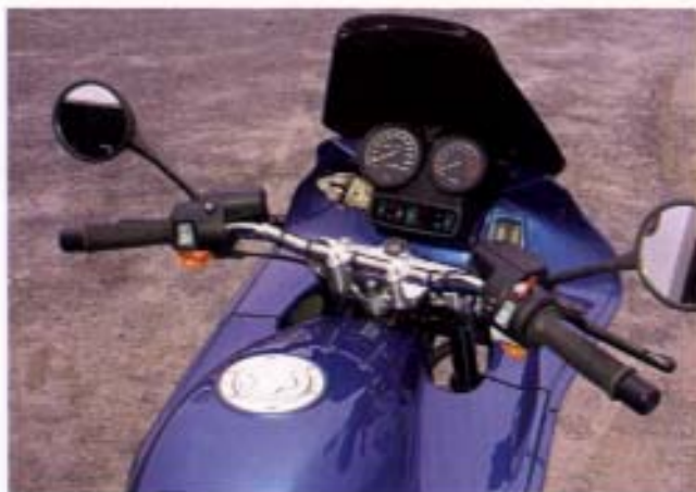
Entspannte Sitzposition für hochgewachsene R 1150/1150 RS-Fahrer dank WÜDO-Aufsatzgabelbrücke
