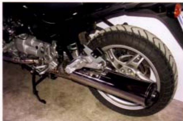
Auspufftieferlegung mit montierter CfK-Blende.
