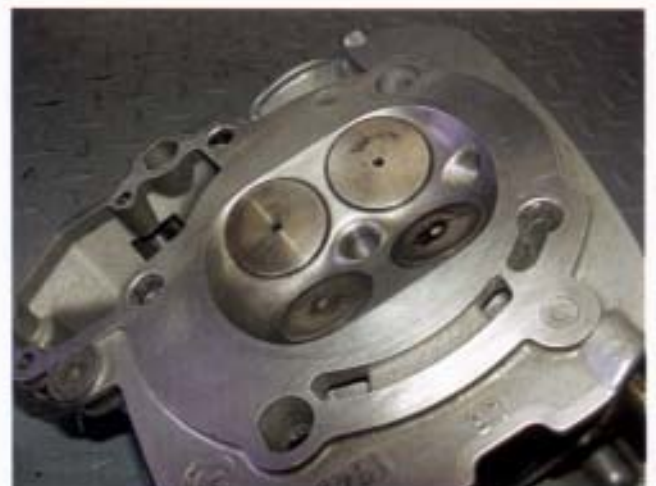
Zwei Kerzen pro Zylinder befeuern das Gemisch richtig.
