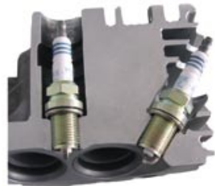
4-V-Zylinderkopf mit zweiter Zündkerze.
